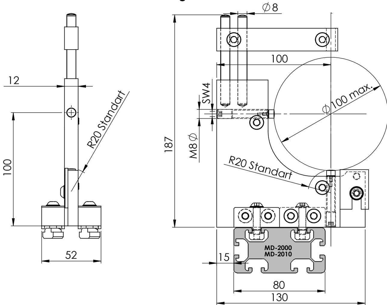
Gewicht der zu messenden Teile wird durch Auflagen ( Teil 4 ) mit Aussengewinde M8 aufgefangen und können schnellverstellt sowie über Innenschkant SW 4 eingestellt werden.
